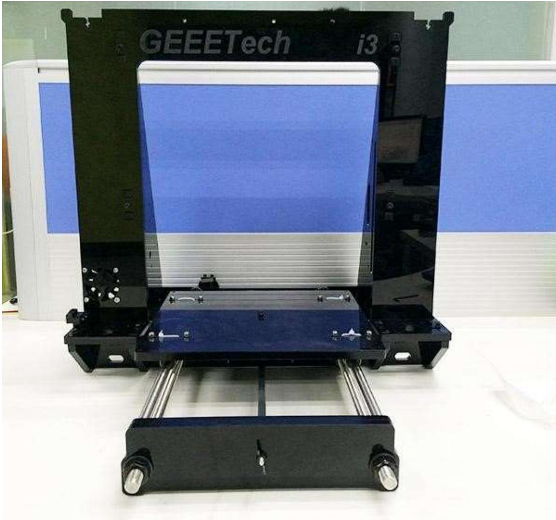
Krok 2: Spojky osy Y přišroubujte čtyřmi šrouby M3x20 k hlavnímu rámu a zajistěte matkami M3. V případě potřeby uvolněte matice na závitových tyčích, aby osa Y přesně sedla do hlavního rámu.
