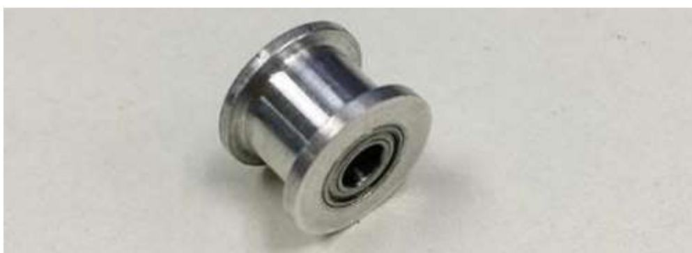
Krok 3: Vložte kladku do držáku a do otvoru vložte šroub M4x25 s podložkou M4. Šroub zajistěte samojistící maticí M4. Matici utáhněte tak, aby se kladka v držáku volně otáčela.
