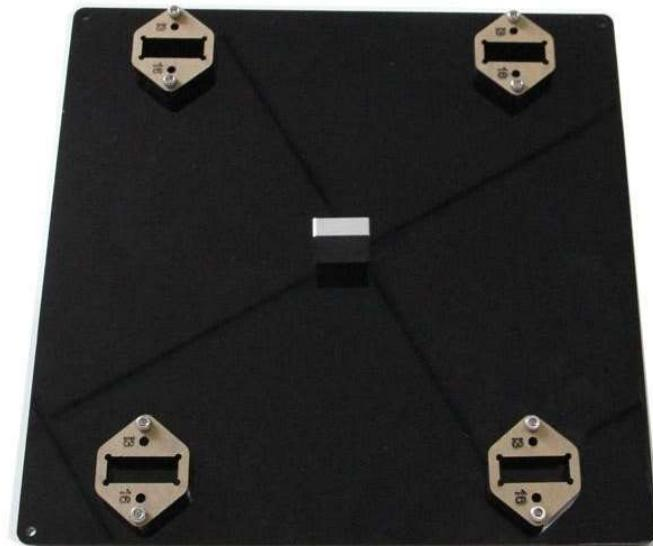
Krok3: Nasadíte tiskovou platformu na vodící tyče tak, aby lineární ložiska zapadla do otvorů v blocích. Následně polohu ložisek zafixujte stahovacím páskem. Přebytečné konce stahovacích pásku odstraňte.
