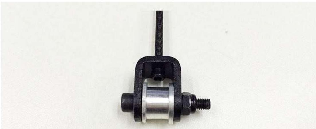
Krok 4: Šroub držáku kladky prostrčte otvorem v přední desce tak, aby byla kladka uvnitř konstrukce. Zajistěte křídlovou maticí.
