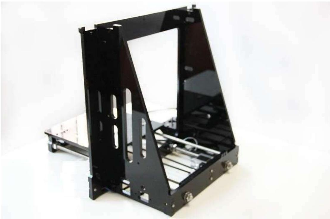
Krok 4: Ujistěte se, že matice na závitových tyčích osy Y jsou na správných místech a pevně je dotáhněte.
