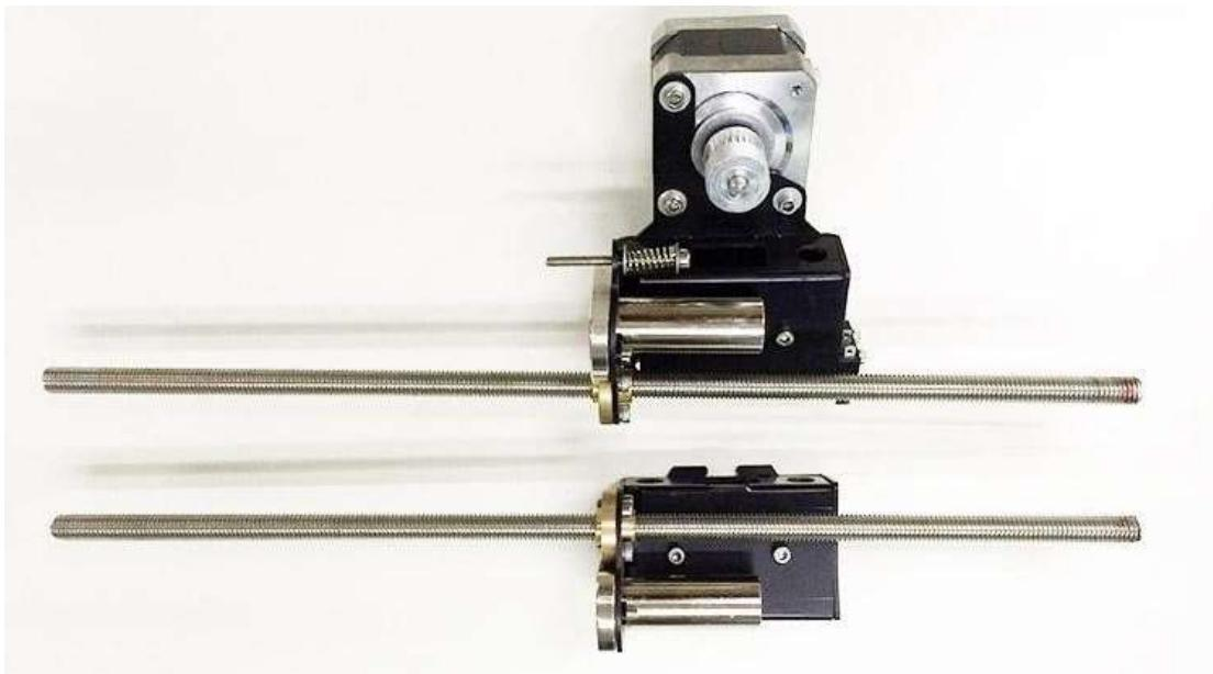
Krok 2: Připojte závitovou tyč nosiče motoru osy X ke spojce levého motoru osy Z. Pevně dotáhněte zajišťovací šrouby spojky. Vsuňte 322 mm vodící tyč (díl 1) do lineárního ložiska nosiče motoru osy X.
