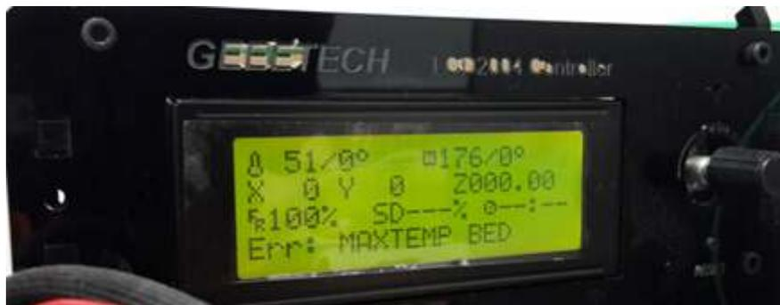
Zkontrolujte zapojení termistorů dle montážního návodu.
