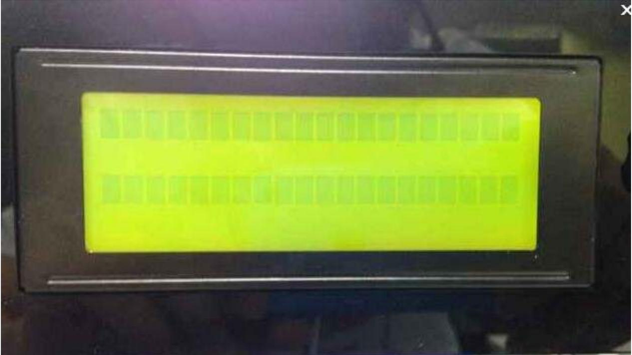
Zkontrolujte zapojení LCD modulu dle montážního návodu. Pokud je vše v pořádku, aktualizujte firmware tiskárny.
