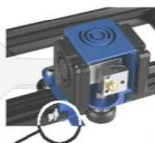
Jeden konec řemene uchyťte v drážce na vozíku tiskové hlavy (hotendu) pomocí vázacích pásků.
